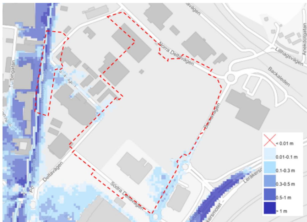
Figur 18. Illustration av prognos för högsta högvatten år 2070 utifrån situationen i dagens Backaplan utan åtgärder. Bild från Dagvatten och skyfallsutredning (Gammal plangräns)
