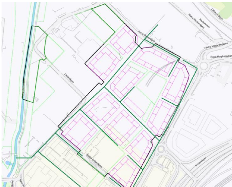
Figur 39. Översikt av principer för det framtida ledningsnätet. Gröna linjer visar dagvattenledningar. Ledningarnas läge är ungefärliga (KoV 22-05-31)
